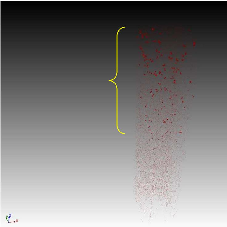
**Fig. 5** Porosity gradient in a diffusion couple CMSX-10/ Ni
